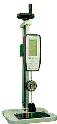
Wiretest I e TI - Semplice verifica manuale di cavi e capicorda.
